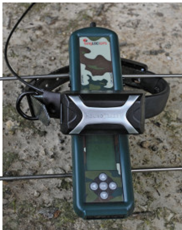
Telemetriergerät mit zusätzlicher GPS-Ortsbestimmung bei guter Verbindung. Relativ teuer und durch den überdimensionierten Akku sehr schwer
